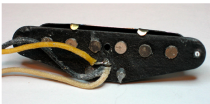
Figura 3. Pickup al manico della Telecaster
