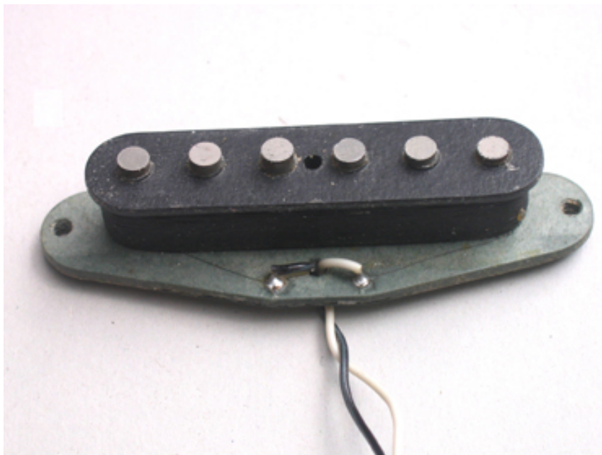
Bild 1. Stratocaster-Tonabnehmer, von Natur aus symmetrisch
